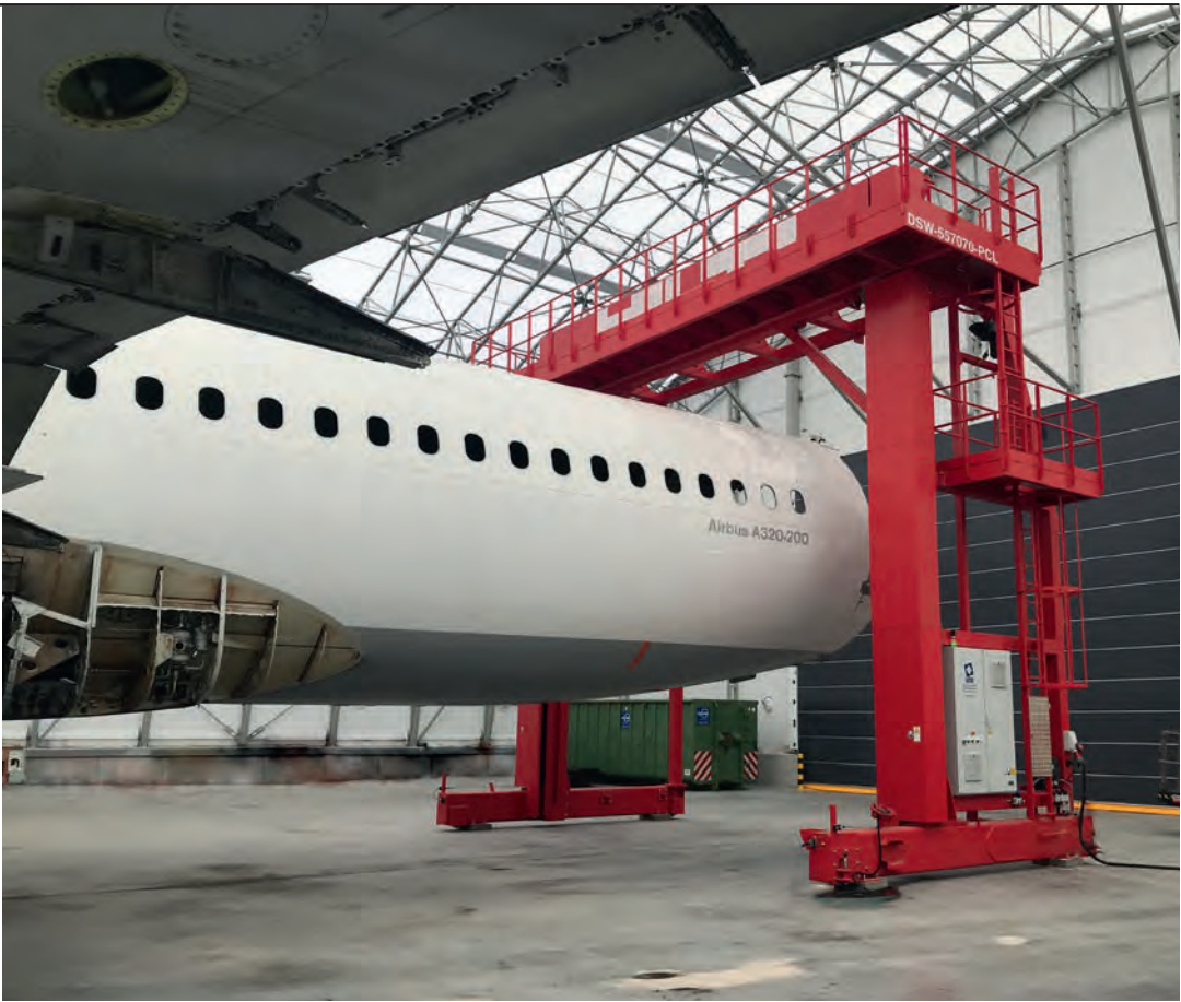
▲ De portaalzaag in Oostende is speciaal gemaakt voor vliegtuigen van het type A320 – B737 (narrow body).
